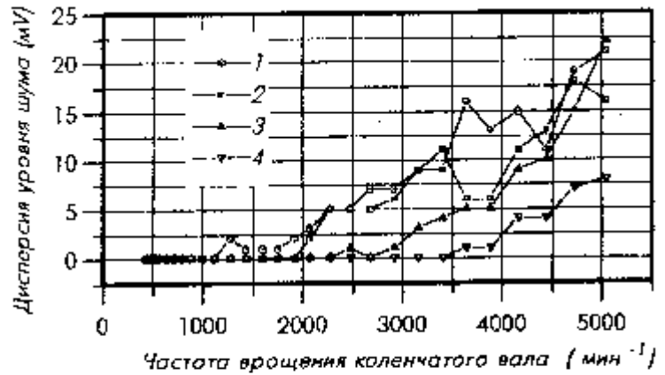
Рис. 5.4.5 Зависимость величины огибающей минимальных значений средней мощности сигнала акселерометра от частоты вращения коленчатого вала двигателя (1-цилиндр 1, 2-цилиндр 3, 3-цилиндр 4, 4-цилиндр 2.).
