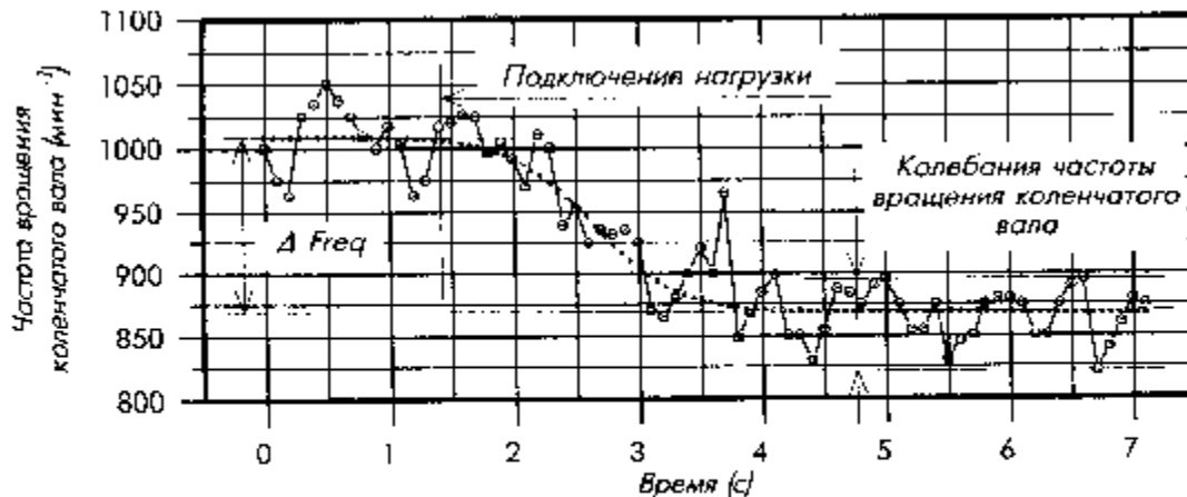
Рис. 7.3.2 Изменение частоты вращения коленчатого вала двигателя, работающего на режиме ОМЧВ, при подключении нагрузки мощностью около 1,1 кВт.
