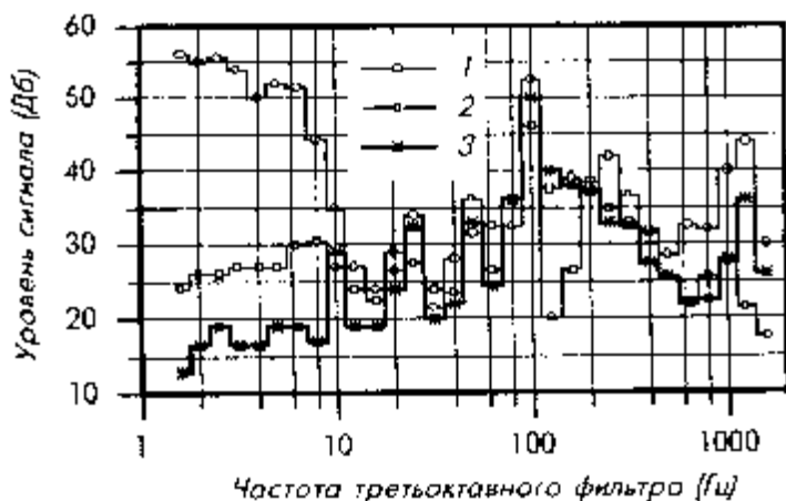
Рис. 3.8.3 Спектральная плотность колебаний абсолютного давления во впускной системе при открытии дроссельной заслонки (кривая 1), при закрытой дроссельной заслонке (кривая 2) и при открытой дроссельной заслонке (кривая 3) ( n=3000 мин -1 , время открытия дроссельной заслонки 0,2 с, максимальные значения при времени усреднения 1/32с)
