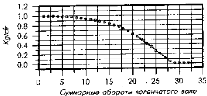
Рис. 4.3.4 Зависимость изменения подачи топлива от количества оборотов коленчатого вала двигателя с начала пуска
