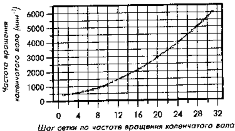
Рис. 8.2.7 Тарировочная зависимость частоты вращения коленчатого вала от положения в сетке таблицы.
