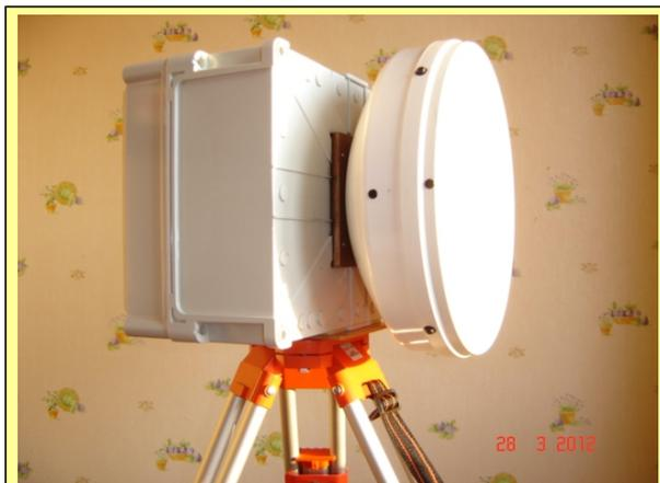
**Трансвертер RV3TD с параболической антенной**
