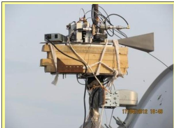
**Трансвертер UA3TCF с рупорным излучателем**
